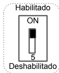
El aumento automático de la sensibilidad hace que la sensibilidad se aumente al máximo en la detección en el vehículo y se mantenga en este nivel durante la presencia del vehículo en el circuito. Cuando el vehículo sale del circuito y se pierde la detección, la sensibilidad vuelve al nivel preestablecido.
